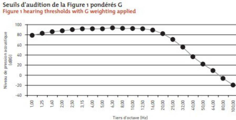
Dans le domaine des fréquences comprises entre 1 Hz et 100 Hz, l'usage de cette pondération sur les seuils d'audition tirés de Møller [12] conduit à un niveau (intégré sur la bande de fréquence) de perception auditive de l'ordre de 102 dB(G).
