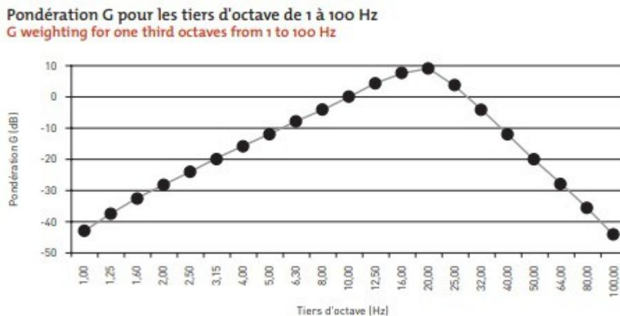
La Figure 2 montre l'allure de cette pondération pour les tiers d'octave de 1 Hz à 100 Hz. L'utilisation de cette pondération sur les seuils d'audition montrés sur la Figure 1 conduit à la courbe de la Figure 3.
